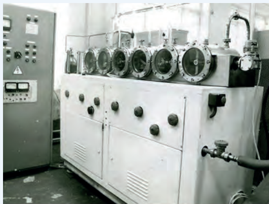
Лабораторная установка УПО-25 для обработки в плазме текстильных материалов. 1981–1982 гг.
